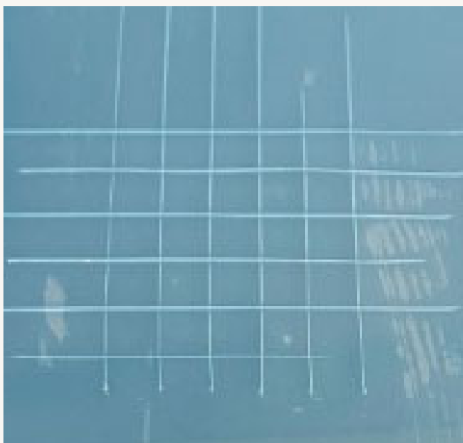
クロスカット試験(JIS K 5600-6)格子幅 3mm 基材 LLDPE シート
